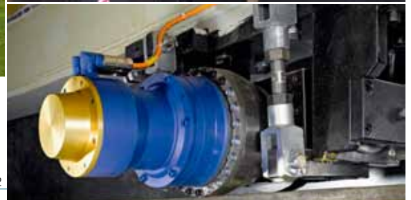
Für harmonische Drehbewegungen: Die Servoaktuatoren TPMA 110 High Torque wurden direkt an die Fahrschemel angeflanscht.
